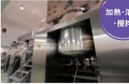
計量された原料をこの大きなタンクに混ぜ合わせ、加熱し溶解、攪拌します。
