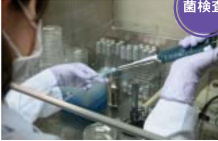
混ぜ合わせたものは、菌検査をし、合格したもののみ容器に充填されます。
