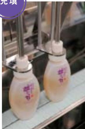
充填機が定量ずつシャンプー液を充填します。さらにその後菌検査に通され、厳しくチェック。
