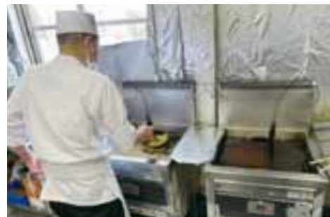
厨房のフライヤー2台に、DENBA F フライヤーの放電板を1枚ずつ設置している。
